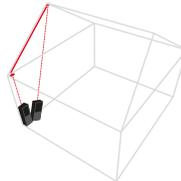
Nach Abschluss der Messung wird die Distanz der beiden Messpunkte automatisch errechnet und in der untersten Zeile des Displays angezeigt. Die Einzelmesswerte stehen in den Messwertzeilen 1 bis 3.
