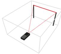
Nach Abschluss der Messung wird die Distanz der beiden Messpunkte automatisch errechnet und in der untersten Zeile des Displays angezeigt. Die Einzelmesswerte stehen in den Messwertzeilen 1 bis 3.
