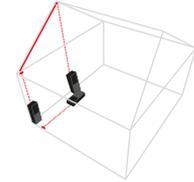
Nach Abschluss der Messung wird die Distanz zwischen dem ersten und dem dritten Messpunkt automatisch errechnet und in der untersten Zeile des Displays angezeigt. Die Einzelmesswerte stehen in den Messwertzeilen 1 bis 3.
